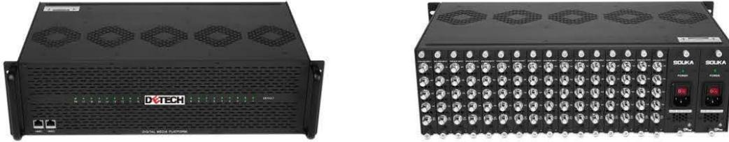
KD30 系列综合前端产品是我公司精心打造的一站式商用音视频解决方案，采用 3U 机身，可支持 16 路功能模块，加 2 路热拔插冗余电源模块，也可支持 18 路功能模块加 1 路电源模块。最新的商用产品设计理念，具备高密度、高性能和高灵活性的特点,并带有记忆功能。支持编复调一体模块、Tuner 接收调制一体模块、高清编码转 IP 模块、Tuner 接收转 IP 模块等，根据选择模块可支持 DVBT、DTMB、ISDB-T、ATSC、DVBC 调制。单台设备能够覆盖酒店及其他商业场所的所有应用方案。
