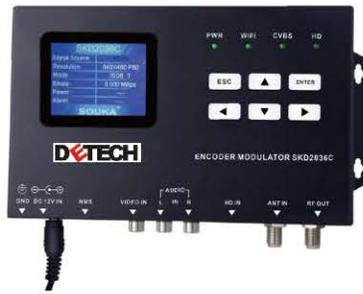
KD203X 系列是我司专门为家庭用户打造的一款数字编调一体机。它能将 HDMI 高清信号或者 CVBS 标清信号通过 H.264 编码后调制成 DVB-T 或者 ISDB-T 射频信号输出再接入同轴电视系统中。机身自带一个射频环路输入口，方便用户将多台 SKD203X 或天线信号进行混合输出。然，可组合成一路输出 16 频点的小前端。
