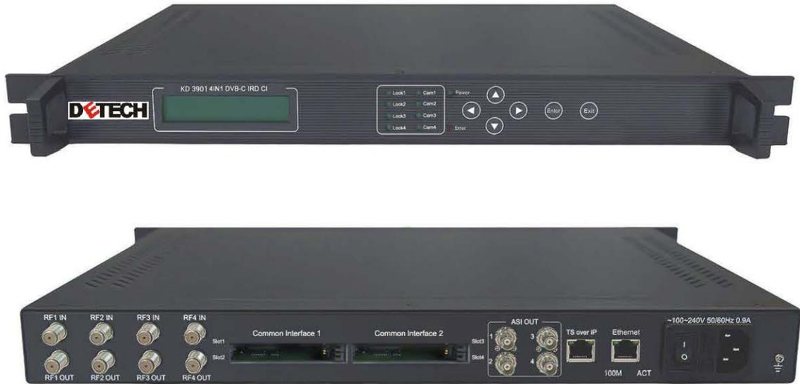
KD3901 是我司的四路有线大卡接收机，设备配置 CAM 解密卡插口，支持 4 路 DVB-C 射频信号；接收 1~4 路 DVB-C 信号解调成 TS 流，经大卡解扰模块选择解扰节目,并通过 4 路 ASI 接口和 IP 口输出。它有 4 个 CI 接口对应 4 路 DVB-C 信号的 TS 流处理解扰，拥有强大的信号接收、解扰功能，满足多种应用需求。
